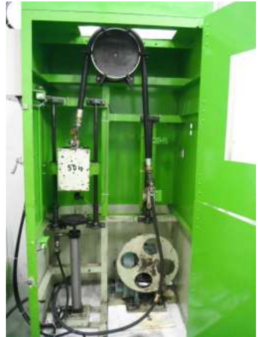
図-1 ドラム巻屈曲試験状況
